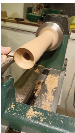
Obr. 13. Vrtání warp hole a obrábění basecupu
