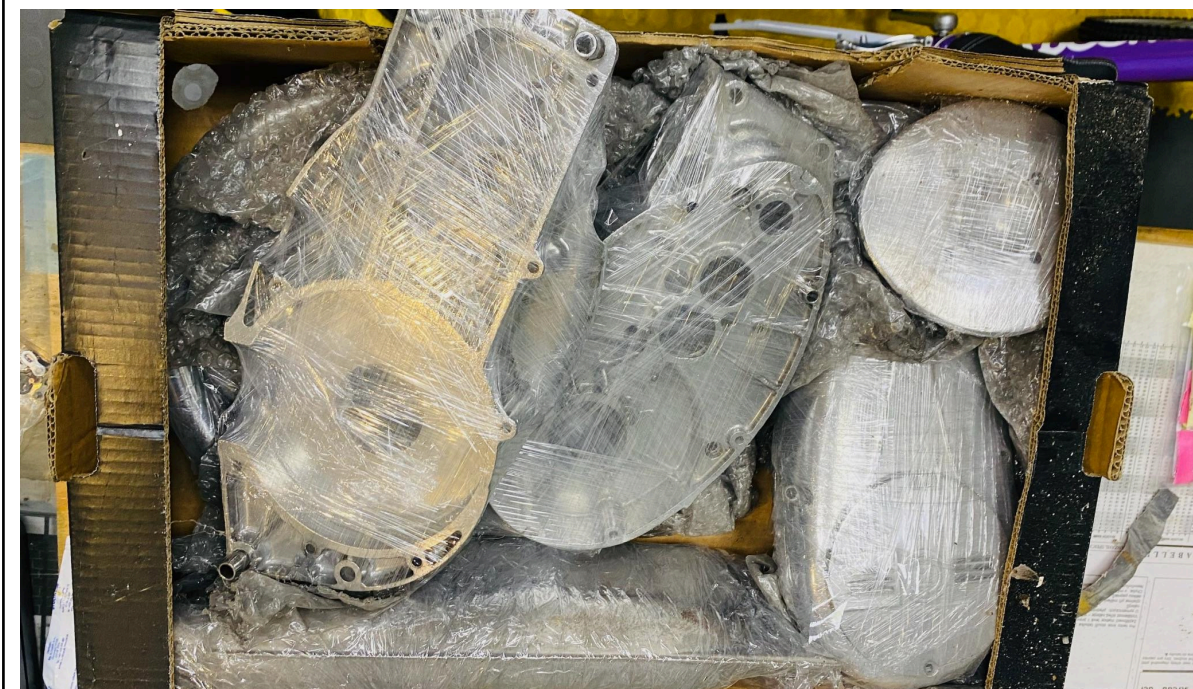
Obr. 2 - rozebraný motor po chemickém čištění
