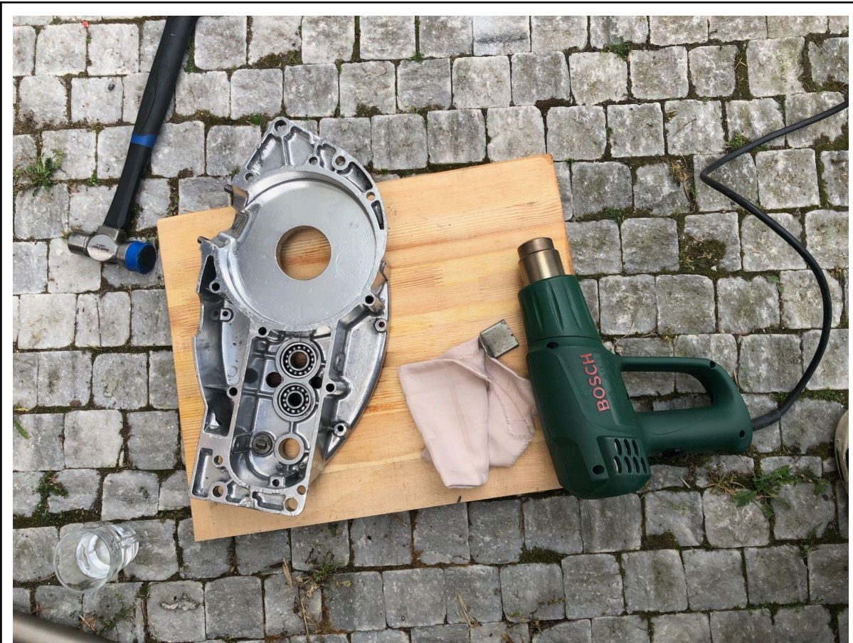
Obr. 16 - vkládání ložisek do karteru motoru
