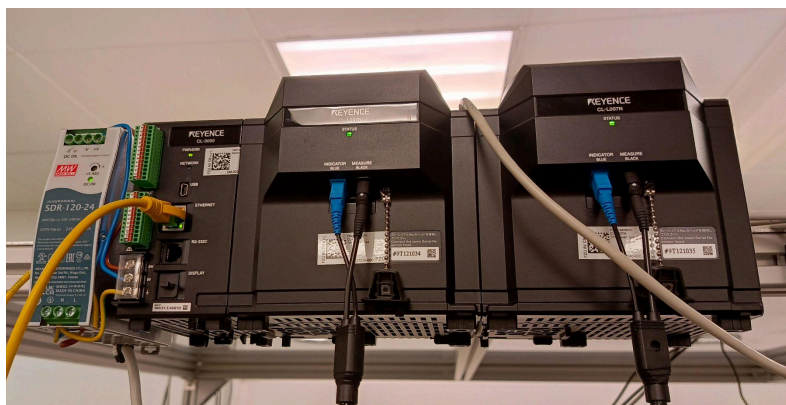
Obr. 12 - Fotografie dvou konfokálních sond v laboratoři na Fyzikálním ústavu AV ČR. Foto vlastní.
