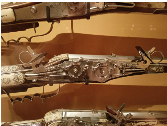
obr. 11, kolečkový zámek, dvojitý, jeden zepředu, druhý zezadu, dvě hlavně, František Kittner
