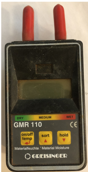
Obrázek.10 Přístroj na měření orientační vlhkosti GHM 110 Greisinger Jde o vpichovací vlhkoměr, který měří elektrický odpor mezi elektrodami. Tento přístroj se běžně využívá k zjištění vlhkosti stavebních materiálů. Výsledky se v přístroji uvádí
