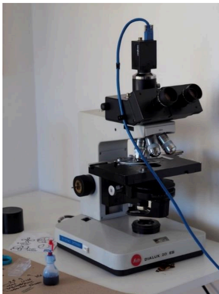
Obrázek 2 - Světelný Mikroskop Leitz Wetzlar s připojenou kamerou
