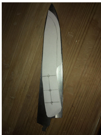
obrázek č. 17 - Vyříznutý nákres nože přiložený na plátu nerezové oceli (rozbitého kuchyňského nože)
