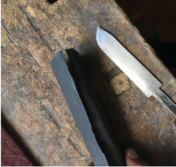
obrázek č. 6 - Obrušování nepotřebného materiálu.
