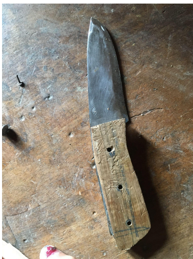
obrázek č. 19 - Vyříznutý nůž pasuje k dřevěné rukojeti.
