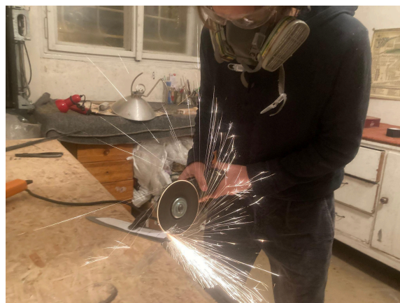
obrázek č. 18 - Vyřezávání nože úhlovou bruskou z ocelového plátu
