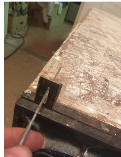
obrázek č. 10 - Pilníkem vybrušování otvoru na čepel.
