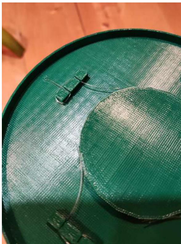
Obrázek 14: Vlákno zaseknuté v zářezech. Soukromý archiv
