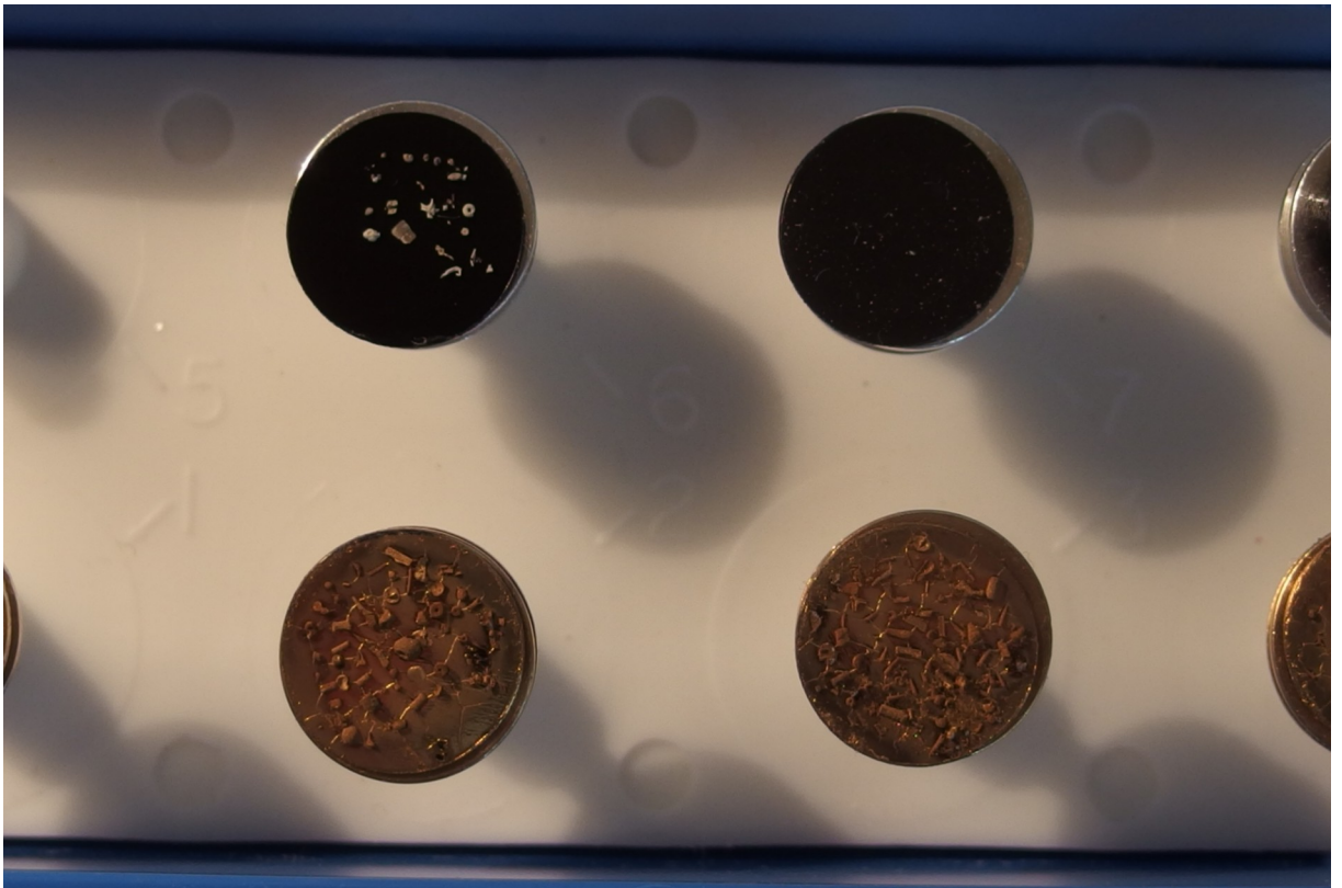
Obrázek 11 Fotografie „stubi“ (nosičů), nahore nepozlacené, dole pozlacené vzorky, foceno pomocí funkce makro ve fotoaparátu (foto autor)Obrázek bů“ (nosičů), nahore nepozlacené, dole pozlacené vzorky, foceno pomocí funkce makro ve fotoaparátu (foto autor)
