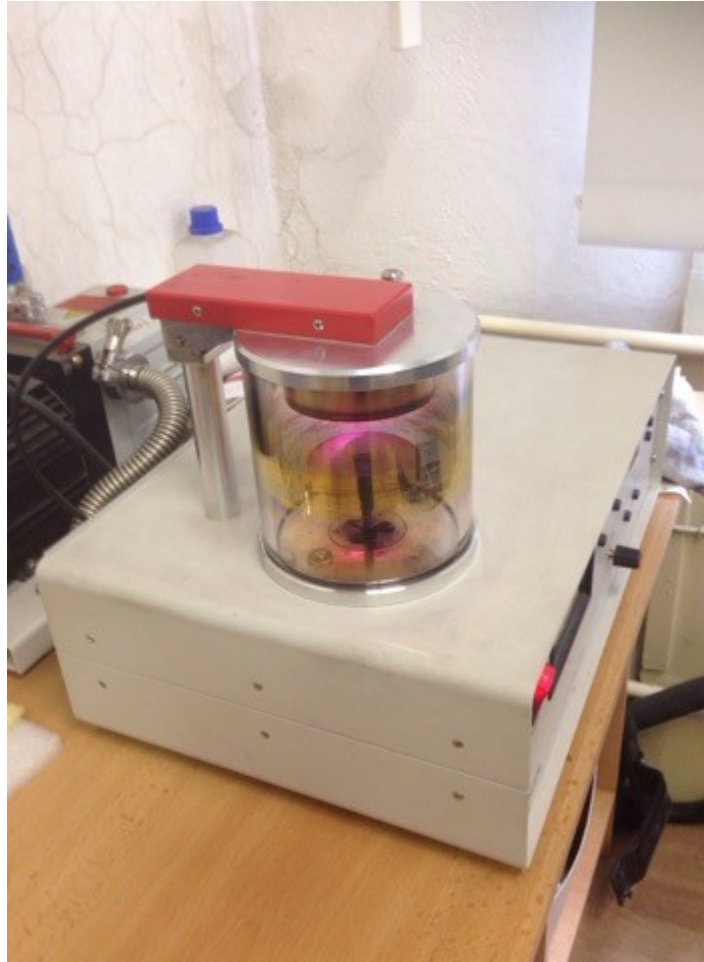
Obrázek 12 Příklad na pozlacení vzorků (foto autor)Obrázek
