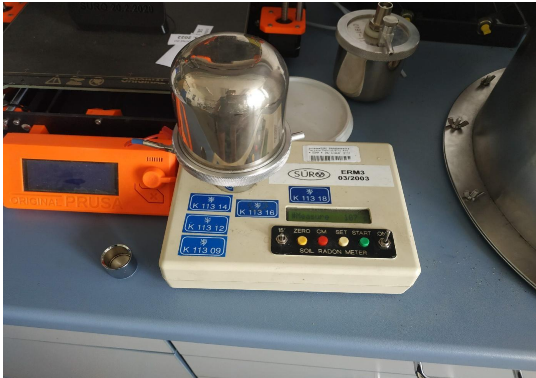
Obr. 3: Měření plynného vzorku elektrometrem ERM3
