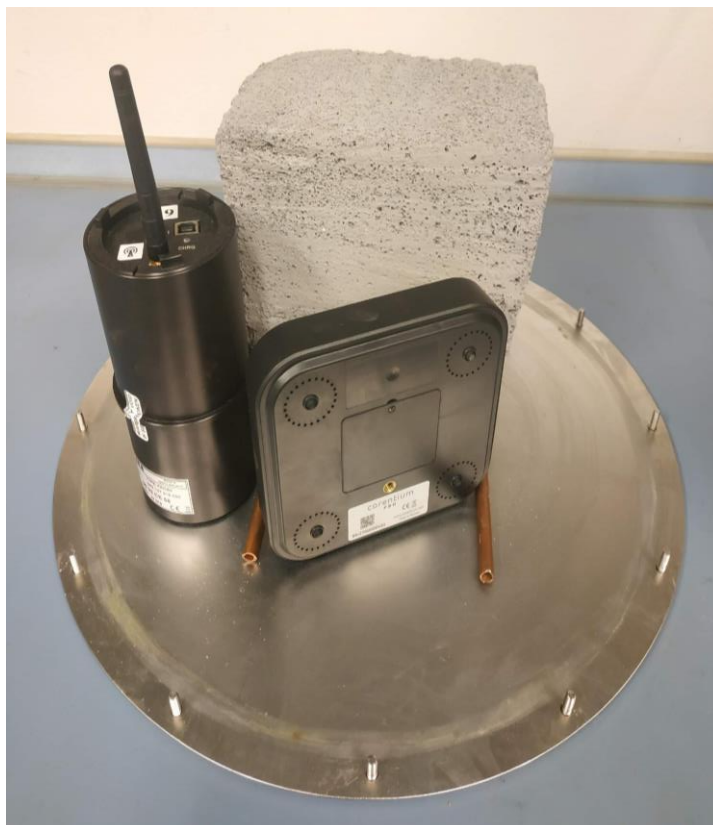
Obr. 4: Umístění sond a vzorku do emanační nádoby
