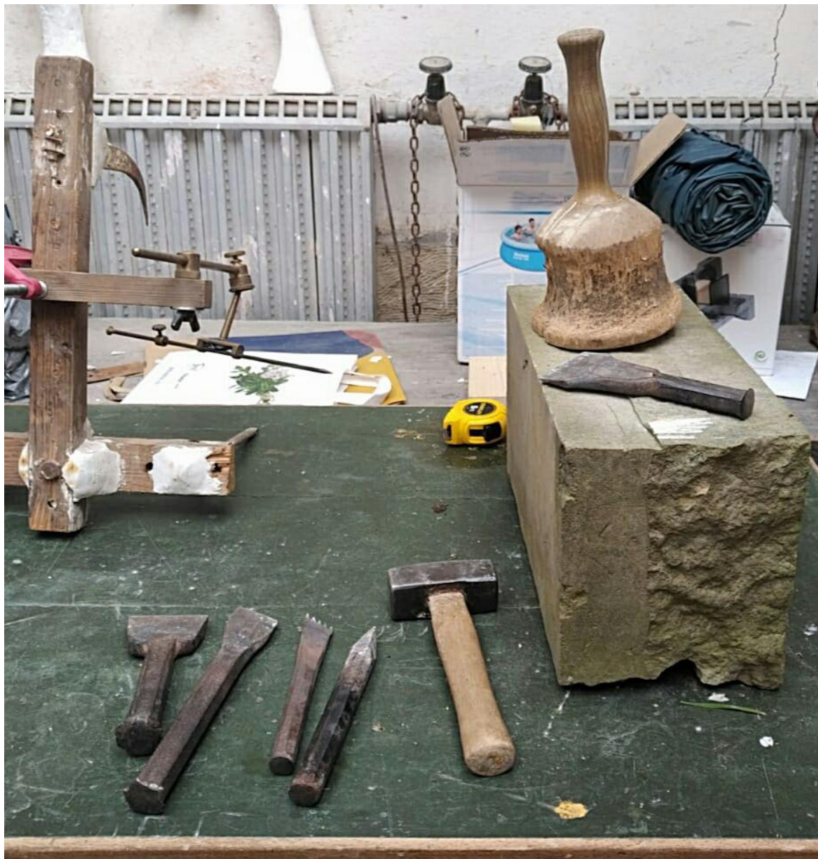
obrázek 21 - nářadí (nalevo je vidět bodovací přístroj)
