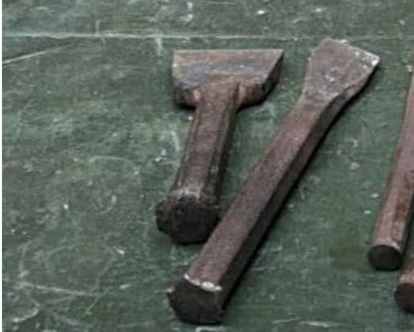
obrázek 5 - prýskač (vlevo) s porovnáním od dláta
