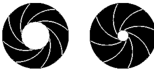
Obr. 2.9 Schéma lamelové (irisové) clony. (Převzato z kvd.zcu.cz)
