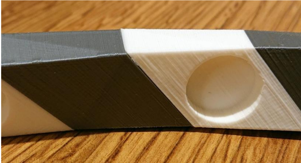
Obrázek 21: detailní pohled na spojení dvou dílů dvoušroubovice
