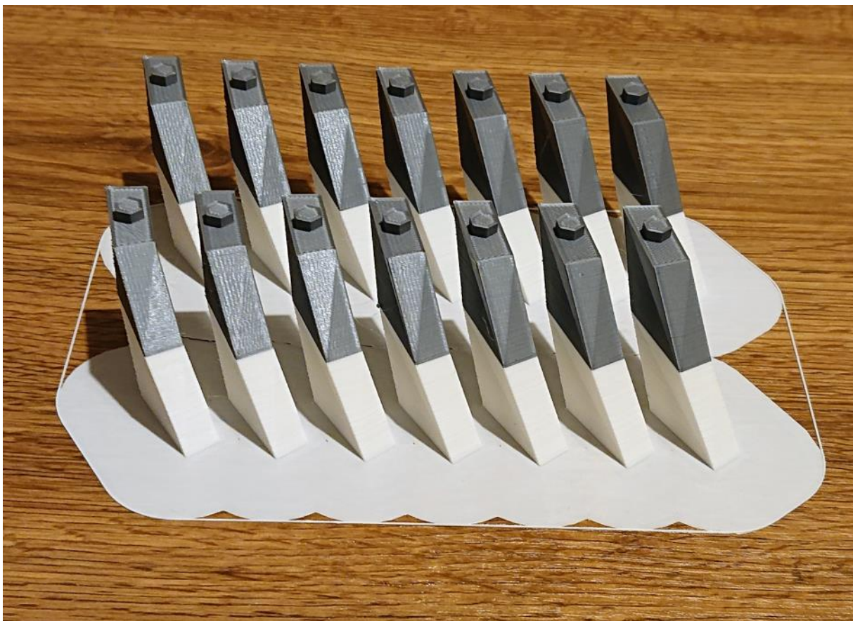
Obrázek 22: vytištěná sada dílů dvoušroubovice včetně límce, který zajišťuje během tisku pevnější uchycení modelu k podložce
