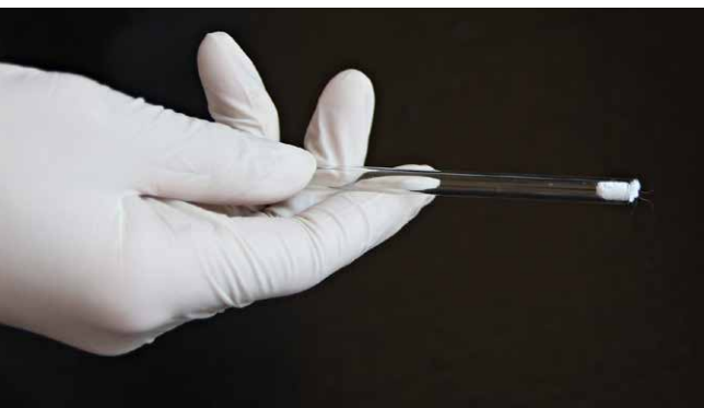
obrázek 2 – Bavlněný knot jako solný můstek
