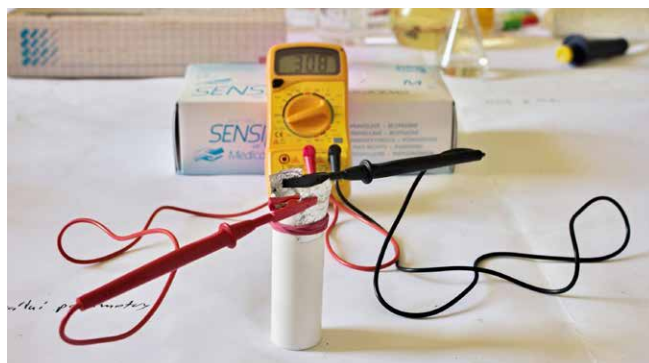
obrázek 7 – Vlastnoručně vyrobená měřicí nádoba
