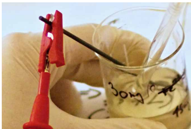
obrázek 1 – Indikační elektroda z tuhy
