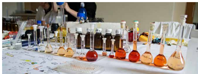
obrázek 4 – Roztoky pro kalibrační spektrofotometrické stanovení (vlevo) a připravené vzorky k analýze (vpravo)
