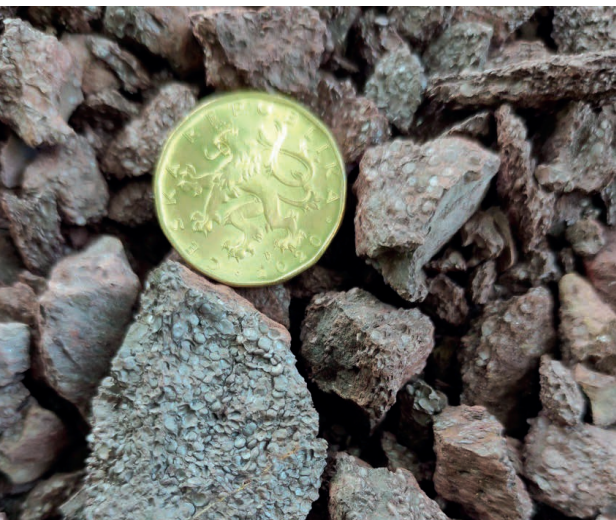
obr. 8: natěžená ruda (hematit) s patrnými oolitickými zrny ve srovnání s dvacetikorunovou mincí
