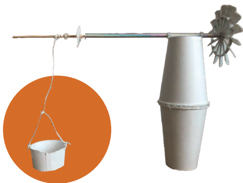
obr. 4: model větrného mlýnu s turbínou vytištěnou na 3D tiskárně
