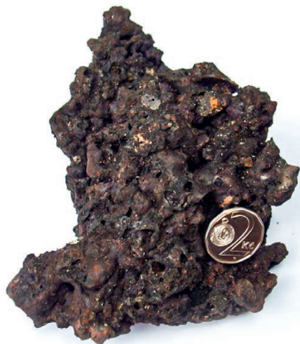
obr. 10: železná houba (struska) vytažená z pece ve srovnání s dvoukorunovou mincí
